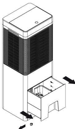
Il peut être de l'ouverture supérieure de la couverture supérieure, remplissant l'eau, puis l'eau ira au réservoir d'eau. Ou il peut être directement au réservoir d'eau, enlever le réservoir d'eau, remplir l'eau au niveau maximum, puis repousser le réservoir d'eau complètement au refroidisseur d'air
